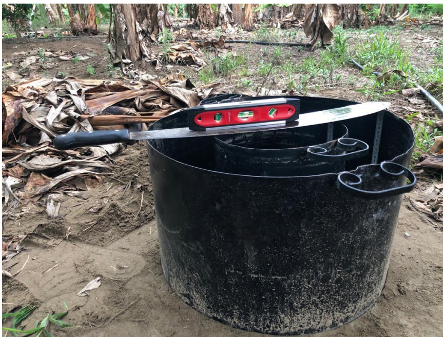
Figura 14 Ensayos de infiltración con el cilindro grande
