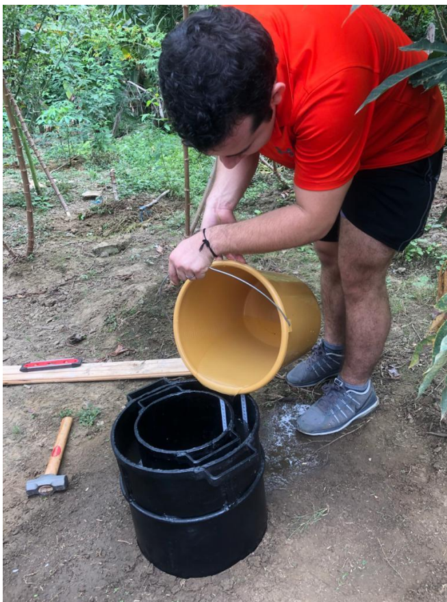
Figura 12 Ensayos de infiltración con el cilindro mediano
