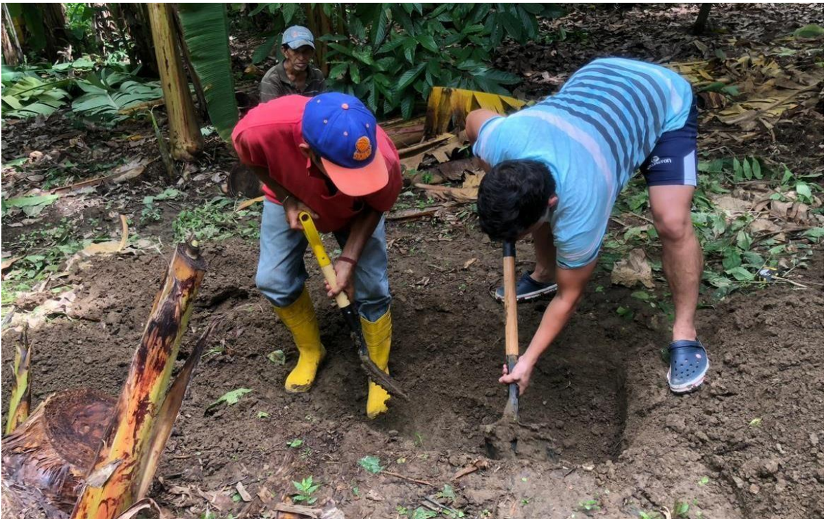
Realización de calicata
