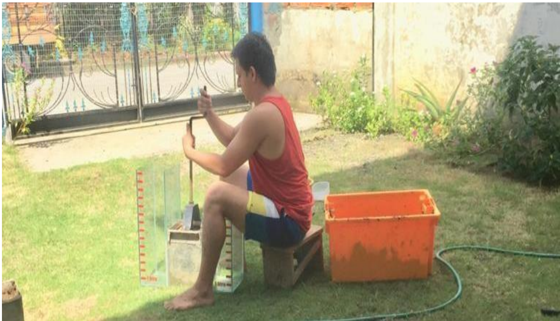
Imposición de la muestra en el equipo con ayuda de una manivela
