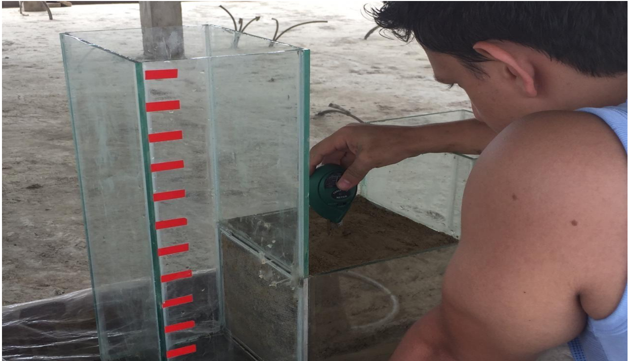
Instalación del sensor de humedad en la muestra
