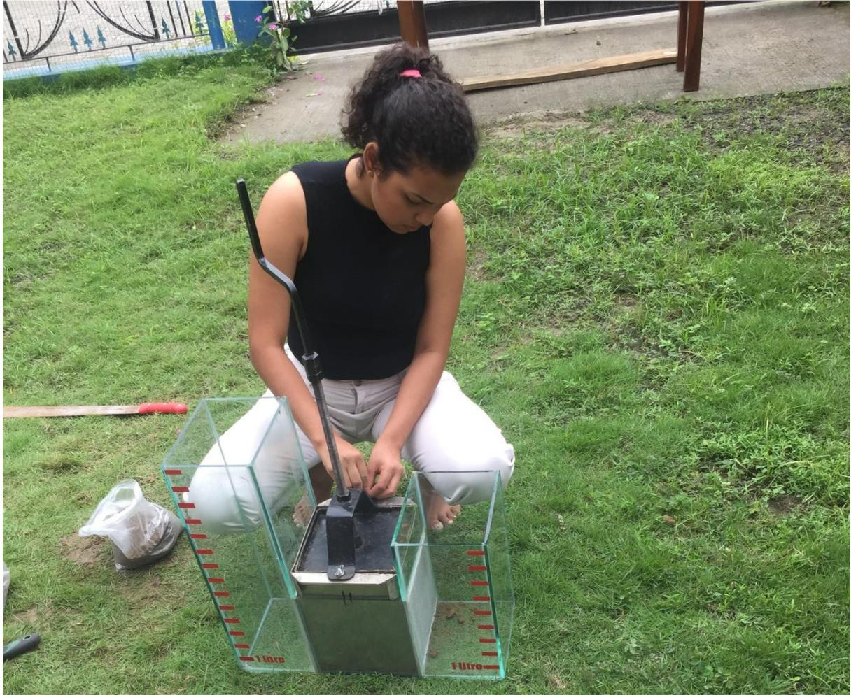
Foto 6 Colocación de muestra de suelo en permeámetro
