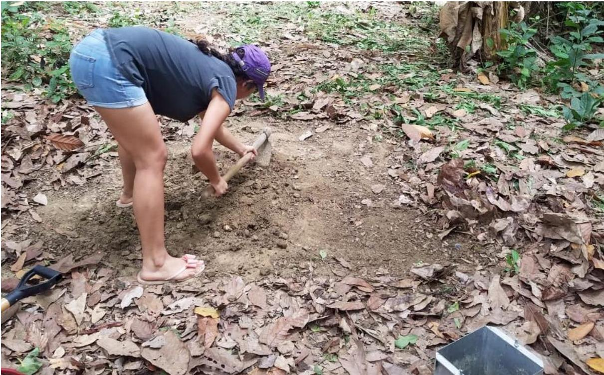
Foto 2 Excavación de la calicata
