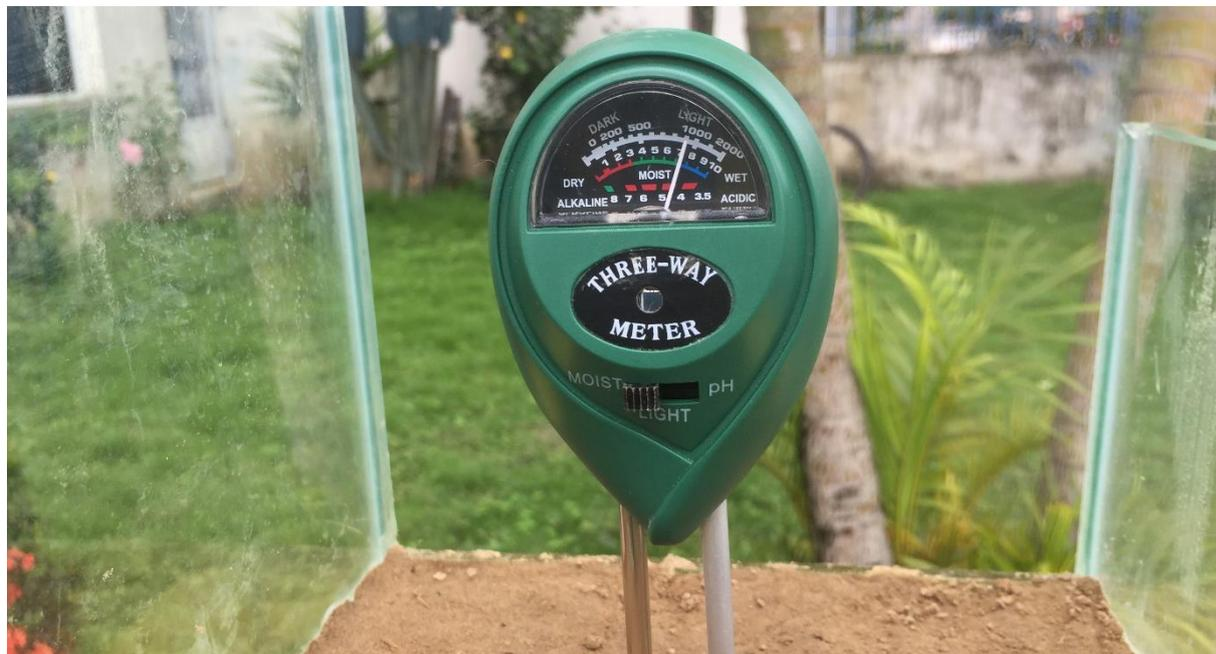
Foto 5 Colocación de sensor de humedad análogo
